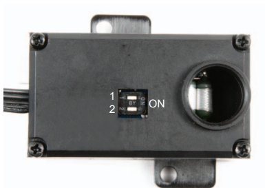
Abbildung 7: Betriebsartenschalter Figure 7: Mode selector DIP-switches
