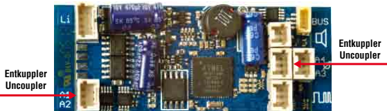
Abbildung 10: Anschlüsse für Automatische Entkuppeler am eMOTION LS Illustration #10: Connections for Automatic Uncoupler on the eMOTION LS
